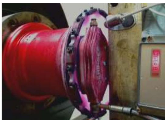
freinage, nous utilisons notre banc d'essai dynamique pour évaluer la capacité d'énergie cinétique du système. Le banc dynamique permet de tester le système de freinage jusqu'à ses limites. De nombreux capteurs permettent de mesurer les températures. Tous ces tests sont réalisés pour garantir une sécurité et une fiabilité totales.
