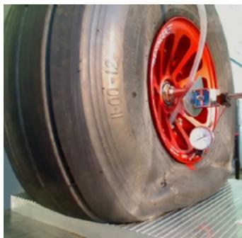
← ↑ Presse hydraulique 44000lbs pour tests de charge ultime sur les roues.
