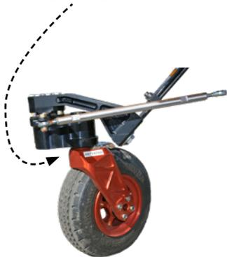
**Position verrouillée :** la liaison roulette-dérive est rigide avec un débattement réglable (la commande de direction se fait aux palonniers)
