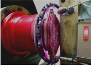
← Test de freinage sur banc dynamique pour évaluer la capacité d'énergie cinétique du bloc frein
