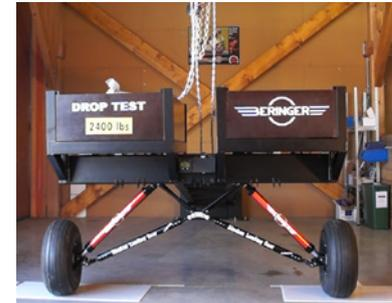
Le train ALG a dû répondre à de nombreux tests pour le process de certification : drop test, test de résistance sur presse hydraulique.
