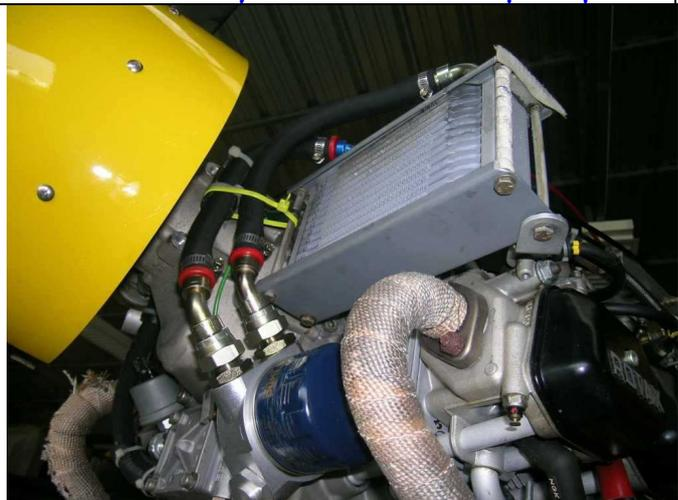
Ne pas oublier de réaliser la connexion entre l'entrée de la pompe et la nourrice d'huile.
